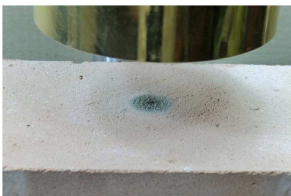
【 耐火煉瓦の焼け跡 】
