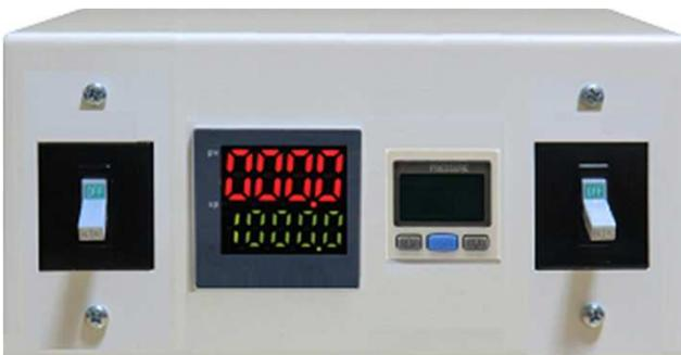
ACCPは主電源スイッチとクーラー始動スイッチが分離しているので、温度設定後に冷却を開始できます。
