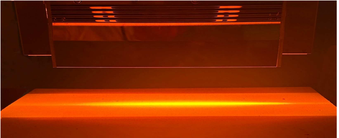
鹵素燈管獲得輻射照度由 HLH-65W/f75/L280 於距離 75 mm 處
