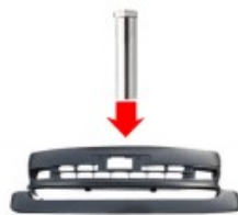
保險槓的去毛刺熔化
